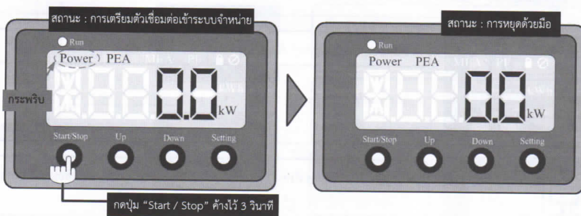
รูปที่ 21 วิธีการหยุดการทำงานด้วยมือขณะขณะโซลาร์อินเวอร์เตอร์เตรียมตัวเชื่อมต่อเข้าระบบจำหน่าย (กลางคืน)
